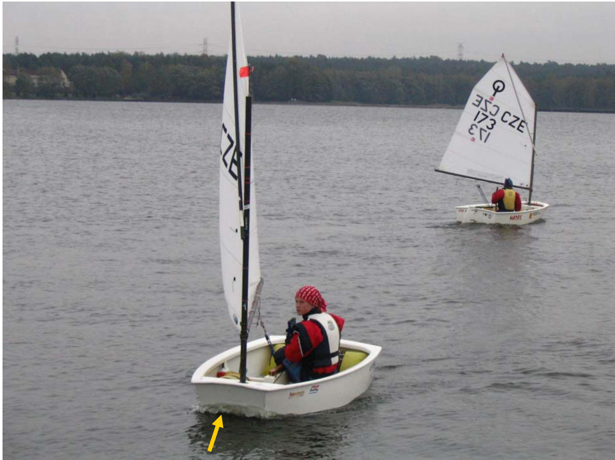
obr. 14 Předozadní stabilita - „hrnutí vody“ při posedu příliš vpředu
