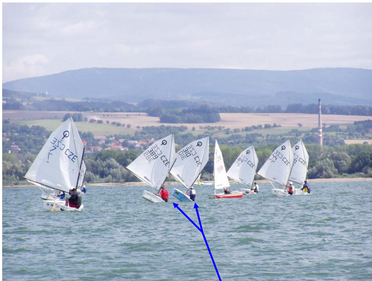
obr.16 Náklon lodě do návětrí v kurzu po větru.
